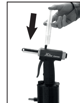
Abb.13, Einfüllen von Öl in die Nietzange mit einer Spritze
