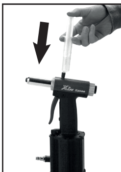
Obr. 13, vnášení oleje do nýtovačky stříkačkou
